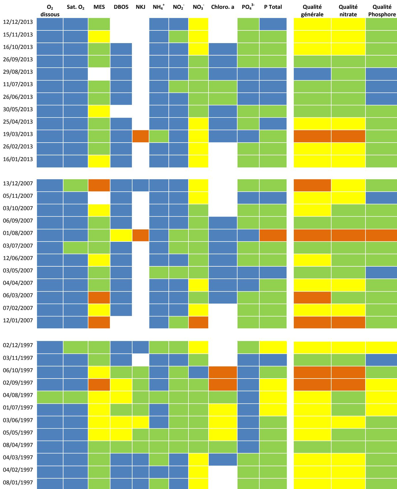
**Matières organiques et oxydables** O2 dis. : Concentration en oxygène dissous / Sat. O2 : Taux de saturation en oxygène / MES : Matière en suspension / DBO5 : Demande biologique en oxygène sur 5 jours
