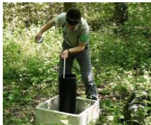
Mesure du niveau de la nappe alluviale à Courpain
