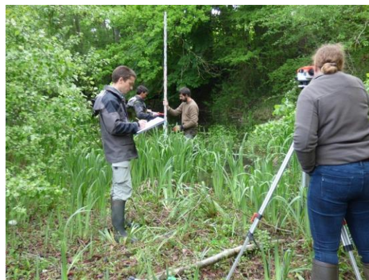
Mesures de la topographie du fond de la mare du Loiret avec le SIBL
