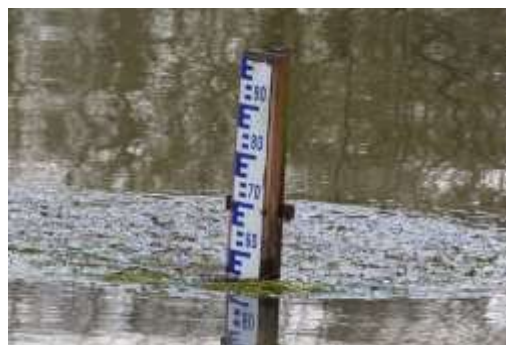
Mesure du niveau du Loiret à l'échelle limnimétrique du Pâtis
