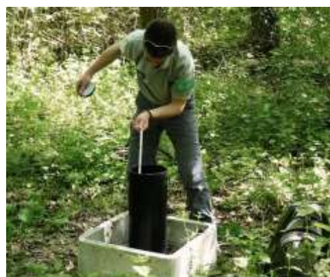
Mesure du niveau de la nappe alluviale à Courpain
