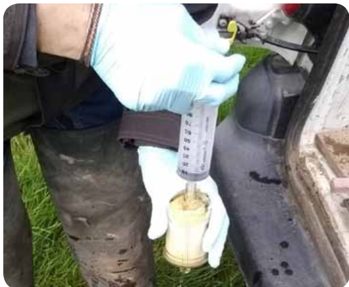
Filtration de l'eau récoltée, avant envoi au laboratoire pour le séquençage de l'ADN © K. Billard
